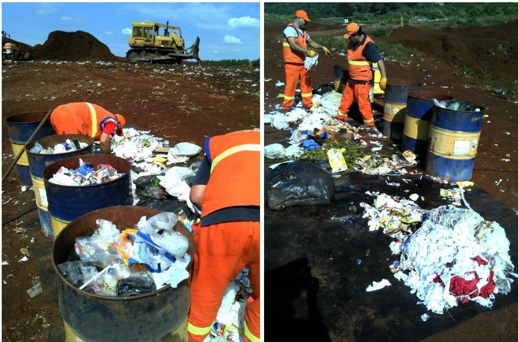
Figura 8: Caracterização de resíduos sendo executada no aterro sanitário.
