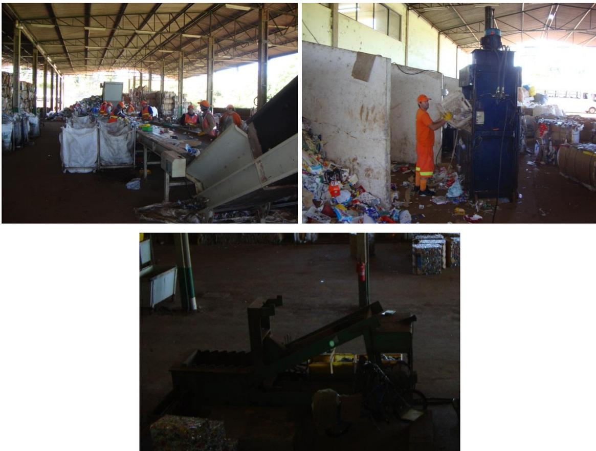
Figura 23: Equipamentos e trabalhadores realizando as atividades de triagem e prensagem de materiais.
