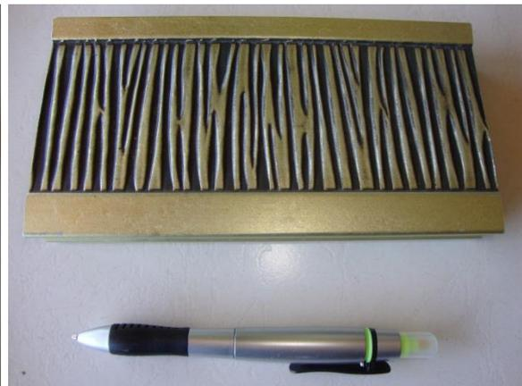
**Figura 25: Isopor moldado para transporte e rodapé fabricado a partir do isopor.**
