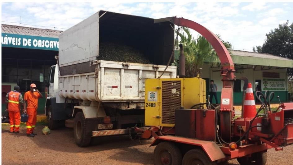
Figura 37: Resíduos verdes picados acondicionados no caminhão coletor para transporte.
