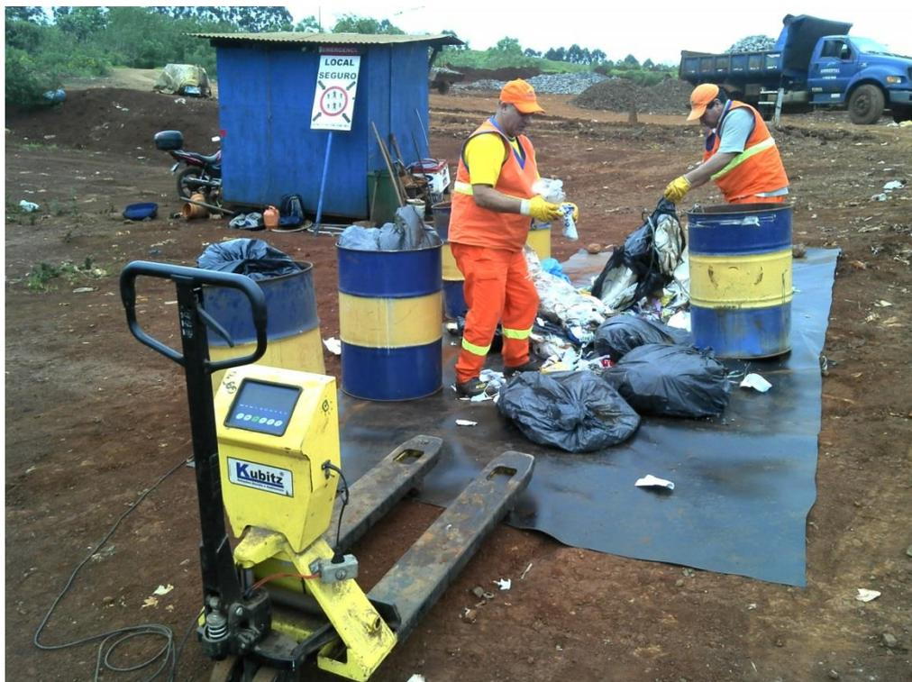
**Figura 9: Pesagem de resíduos sendo executada no aterro sanitário.**
