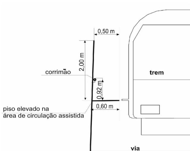
Figura 13 — Área de circulação assistida de usuários com piso elevado – Corte – Exemplo
