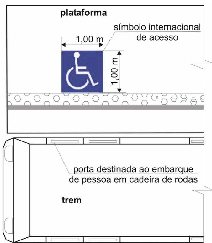
**Figura 56 — Sinalização visual no piso, no local de embarque, para a pessoa com deficiência ou com mobilidade reduzida – Planta**
